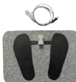
calzatura- elettrodo per verifica connessione calzatura destra e sinistra attraverso antenna
